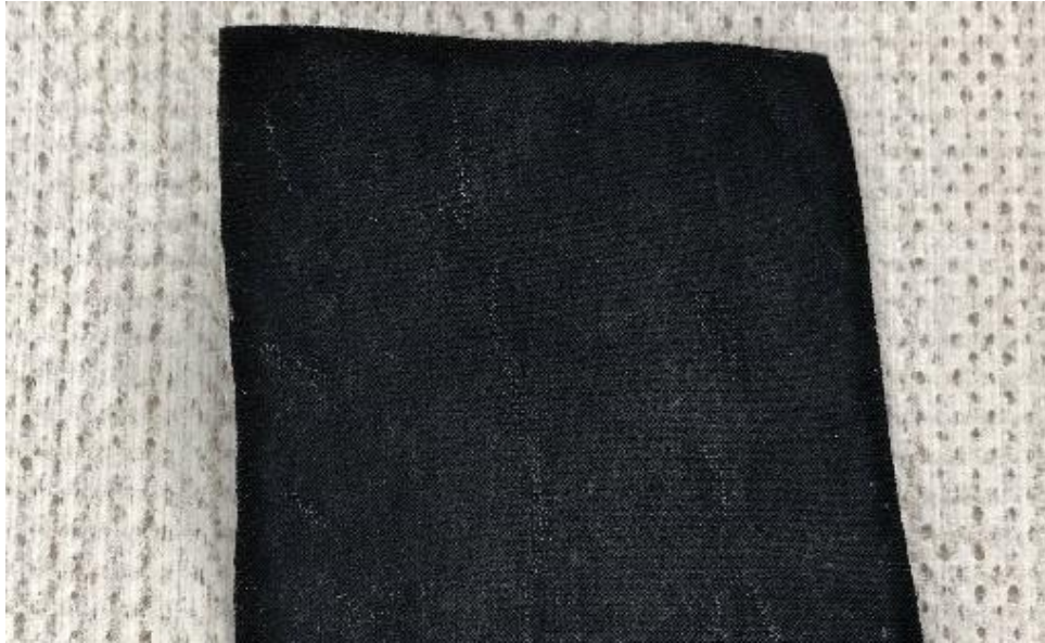
Textil I mit modifizierter ORMOCER-Beschichtung
